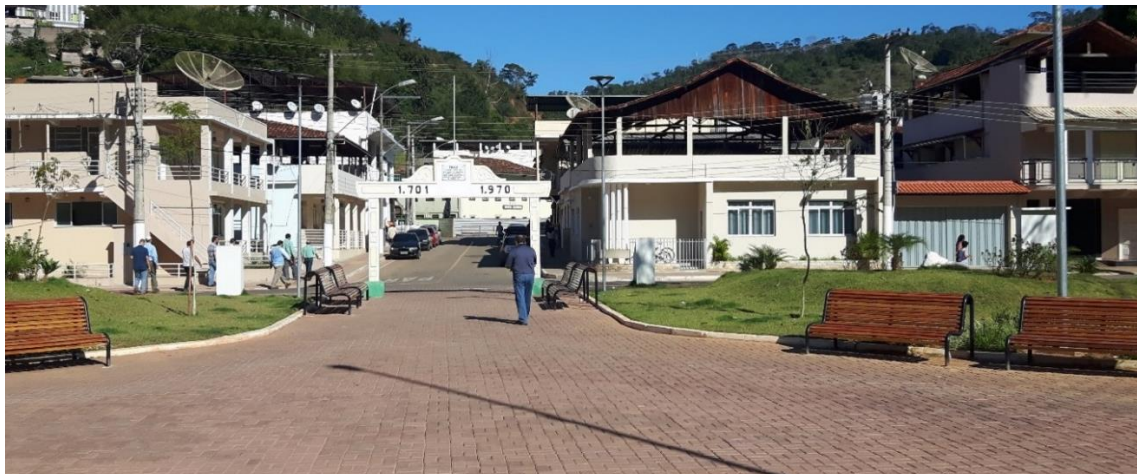
Figura 6.2.2-4: Praça de Barra Longa recuperada com calçamento revestido de piso intertravado que contém em sua composição resíduo de mineração.
