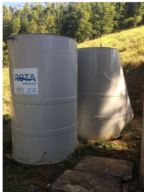
Fotos 5 e 6: Reservatório de polipropileno (5.000 litros) rompido – Gesteira /Barra Longa (Arquivo Ramboll, 2019)
