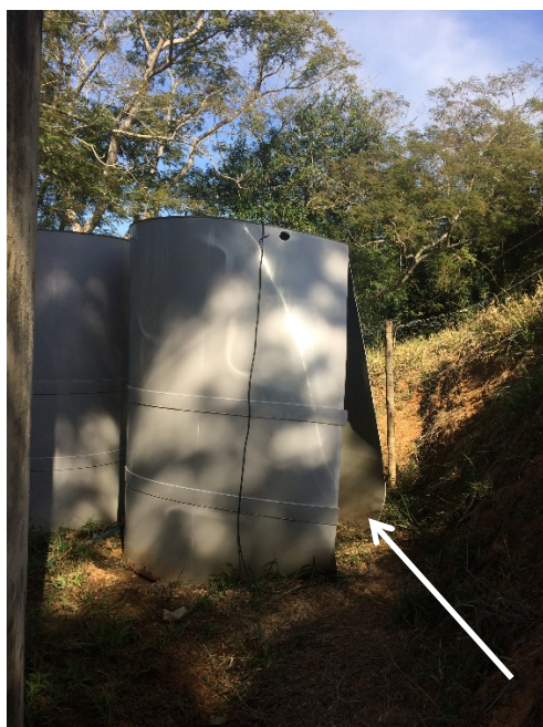
Fotos 5 e 6: Reservatório de polipropileno (5.000 litros) rompido – Gesteira /Barra Longa (Arquivo Ramboll, 2019)
