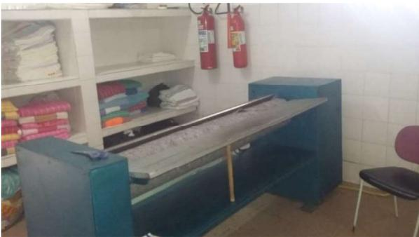
Foto 16: calandra com paliativo (destaque) para suporte da estrutura.
