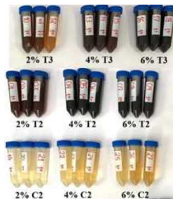
Figura 14: Aspecto dos lixiviados dos condicionadores de solo
