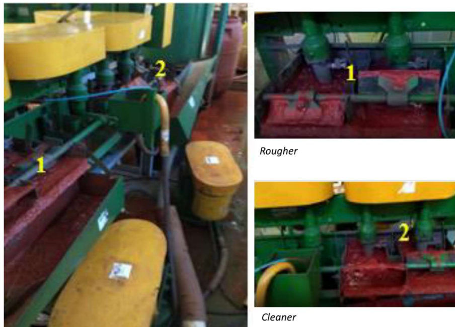
Figura 6: Equipamentos utilizados na flotação para produção em protótipo do concentrado de ferro
