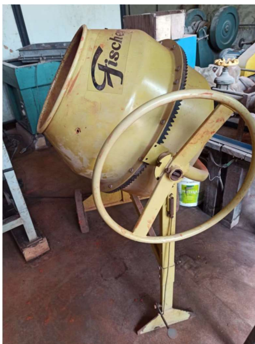
Figura 49: Betoneira utilizada na rota de produção de agregados via tambor rotativo a seco
