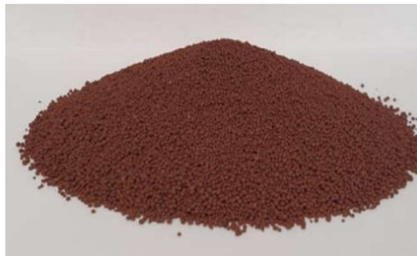
Figura 24: Propante cerâmico produzido em escala de protótipo com resíduo de bauxita
