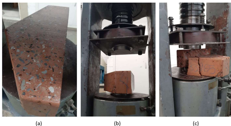
Figura 28: Ensaio de resistência a compressão dos pisos intertravados
