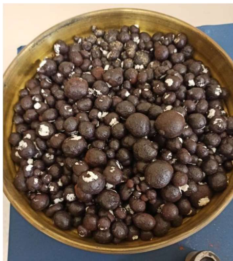
Figura 50: Agregados sintéticos produzidos por tambor rotativo a seco, após sinterização
