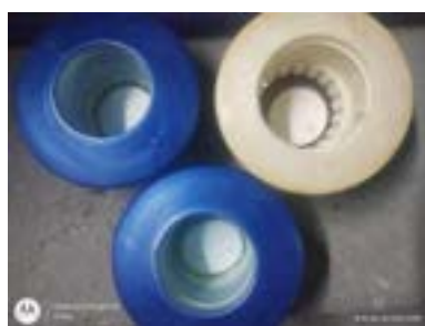
Flutuadores de cloro após limpeza
