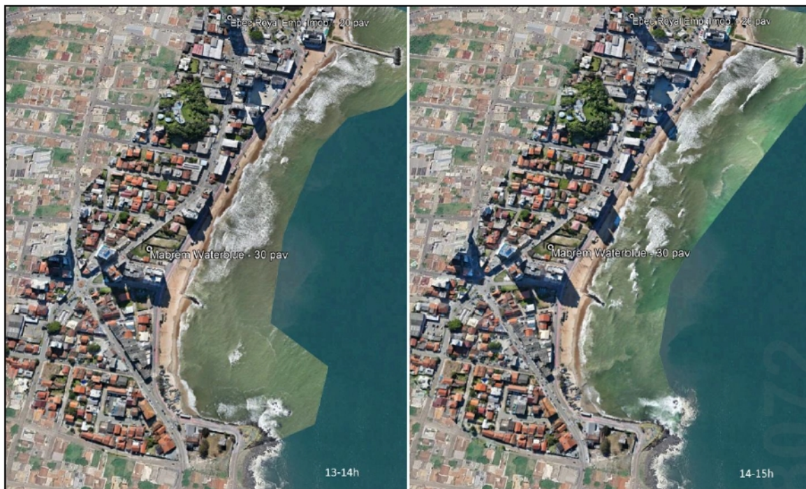
Figura 04. Sobreposição do mosaico de imagens sobre a imagem de satélite (Google Earth) na Praia Central, datada de 13/07/2026, comparando os intervalos de 13h–14h (à esquerda) e 14h–15h (à direita). Constata-se o avanço da sombra sobre a restinga e a faixa de praia, decorrente de edificações com até 15 pavimentos. Entre 14h e 15h, o sombreamento da faixa de praia é total ao norte e parcial ao sul. Ressalta-se que o Edifício Waterblue (projetado com 30 pavimentos) ainda não foi construído e não compõe o sombreamento retratado.
