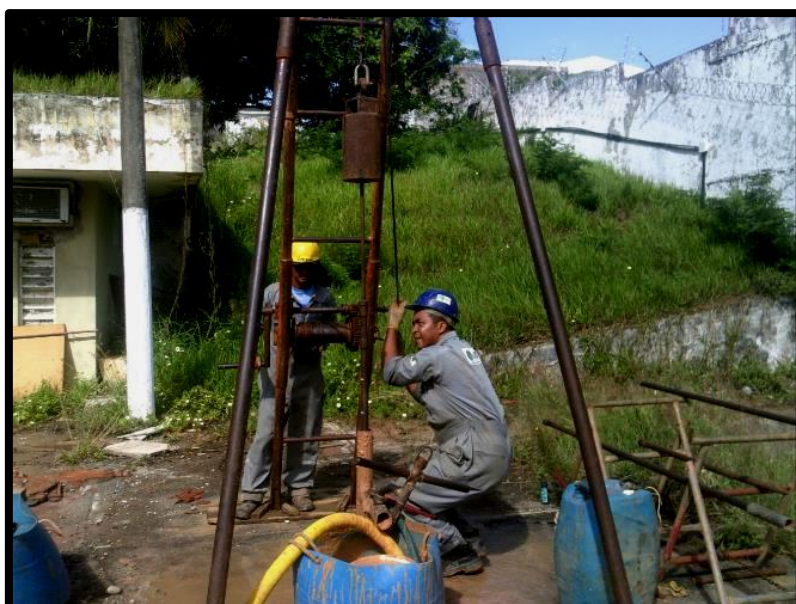
Figura 4: Execução da sondagem SPT na área do empreendimento.
