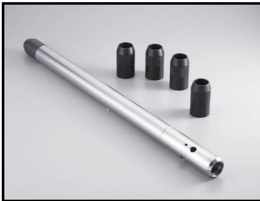
Figura 1: Amostrador bipartido de SPT.
