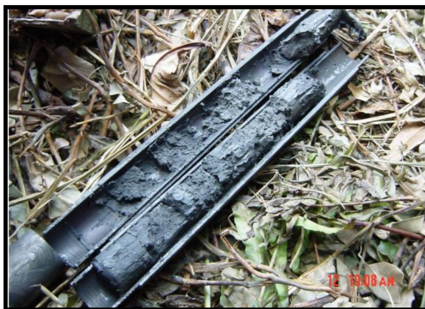
Figura 2: Amostrador Bipartido de SPT com amostra de solo. Banco de dados MAP Ambiental.
