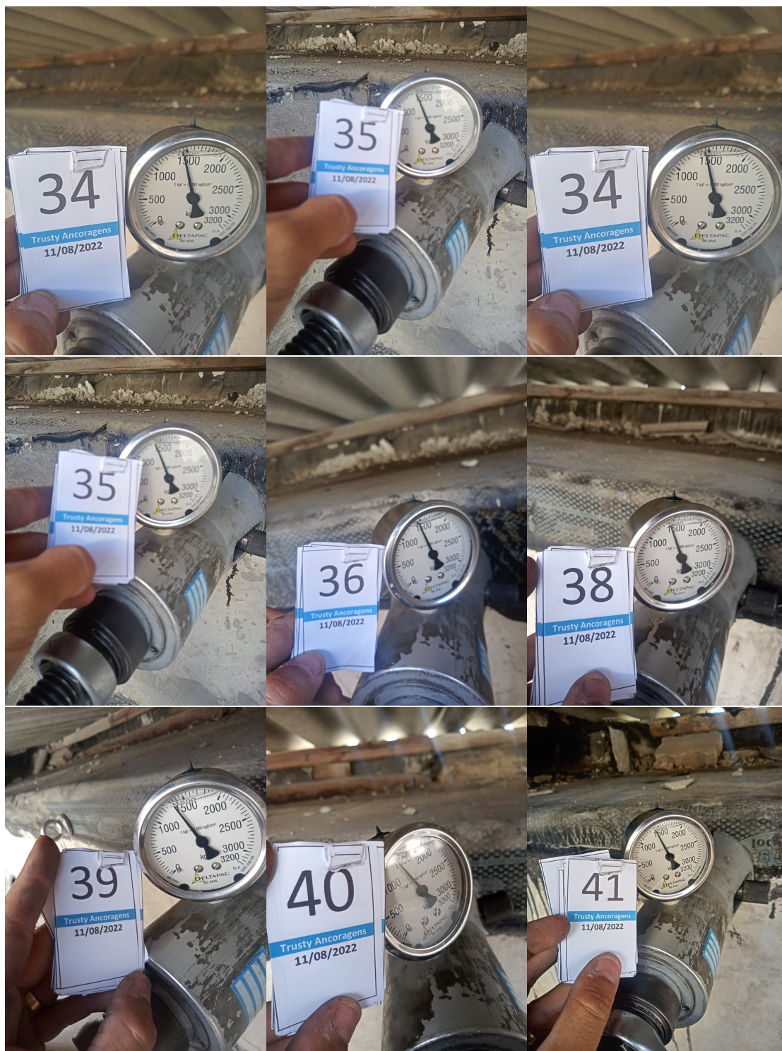
Fotos: Ensaio de carga do Sistema de Ancoragem do PRPE.
