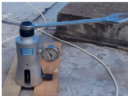
Foto 02 – Dinamômetro fabricado pela Deltapac.
