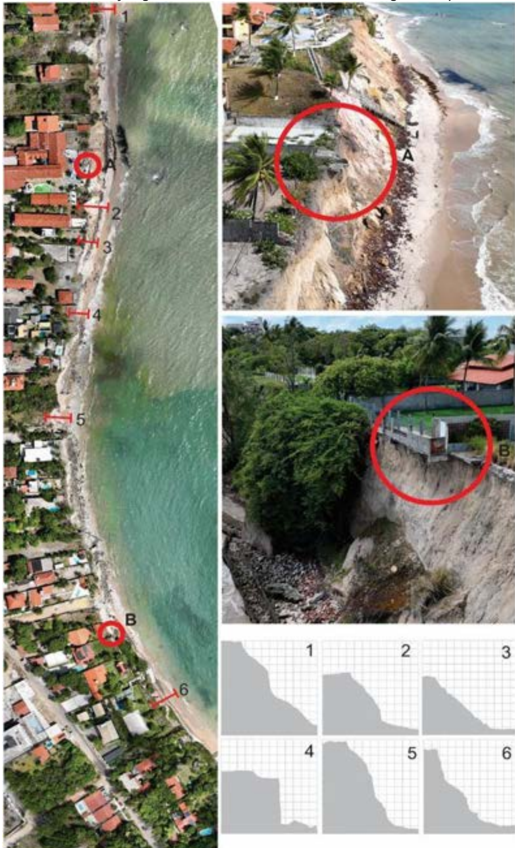
Figura 12: Perfis topográficos e morfologia da falésia (elaborados a partir de modelos digitais de elevação gerados através de técnicas de aerofotogrametria)
