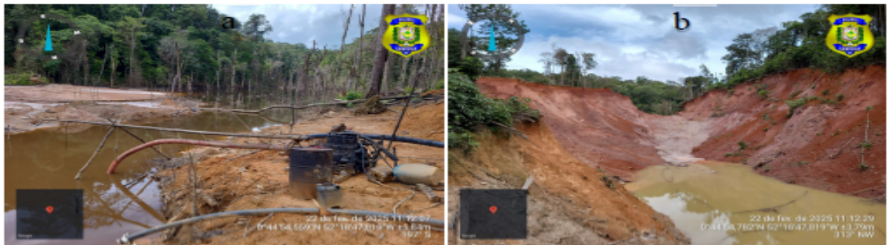
Bomba e mangueiras utilizadas na captação de água para o processo de desmonte hidráulico (a) e a vala de exploração (b)
