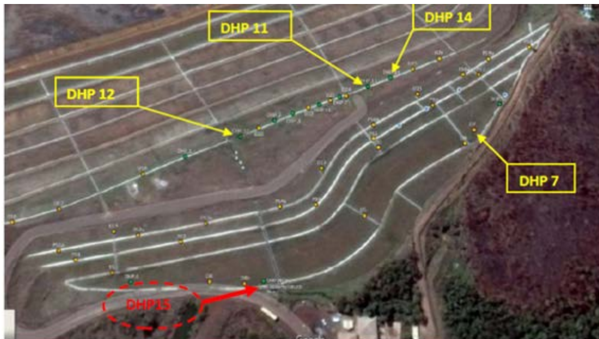
Figura 9. Posição dos drenos sub-horizontais profundos, instalados em 2018 (CIAE-SB).
