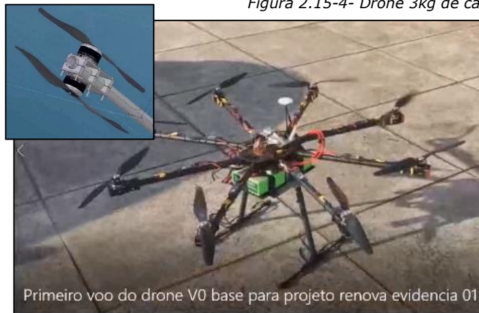
Figura 2.15-4- Drone 3kg de carga
