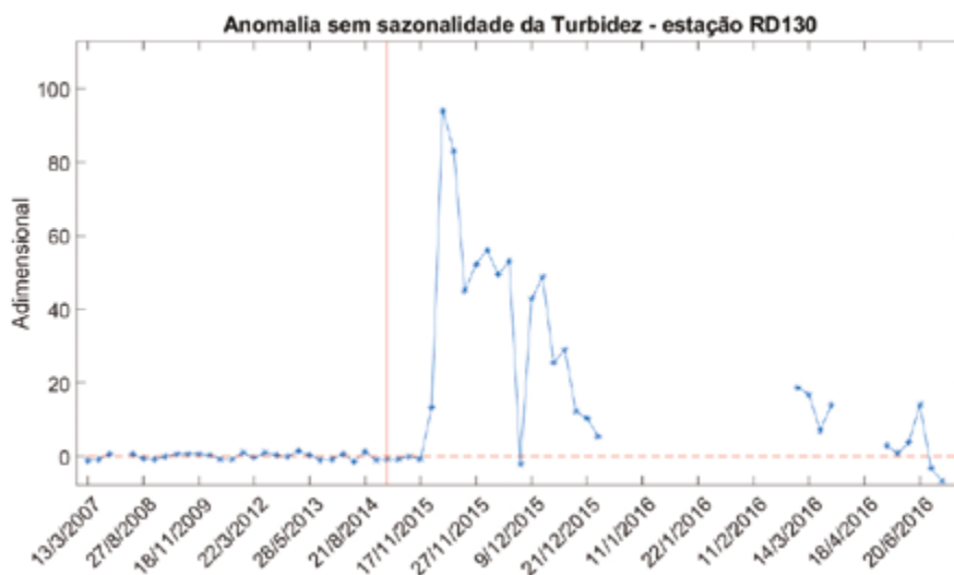
Figura 90 – Anomalia sem sazonalidade da turbidez para a estação RD130, localizada no rio Doce. Anomalia igual a zero (linha vermelha tracejada) antes e após a data do rompimento da barragem de Fundão (linha vermelha contínua).
