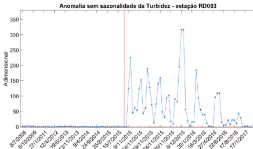
Figura 89 – Anomalia sem sazonalidade da turbidez para a estação RD083, localizada no rio Doce. Anomalia igual a zero (linha vermelha tracejada) antes e após a data do rompimento da barragem de Fundão (linha vermelha contínua).
