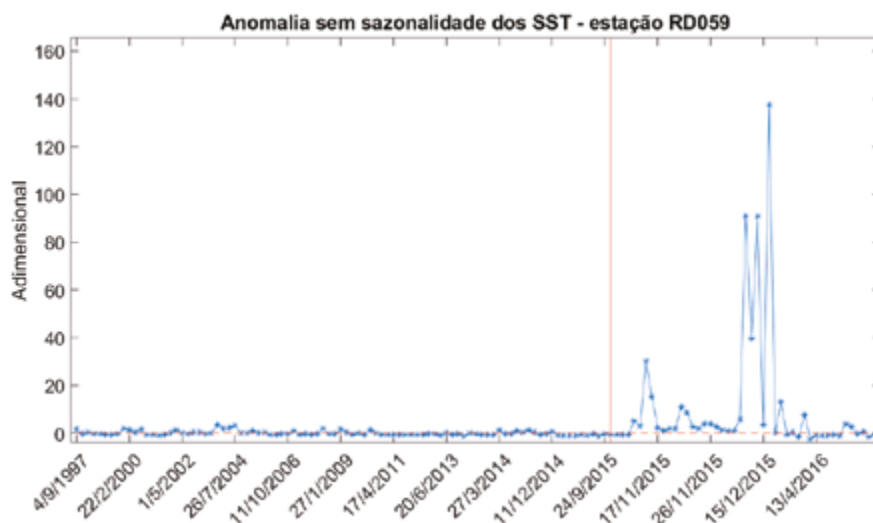
Figura 99 – Valores de SSTs ao longo do caminho da onda de rejeitos em novembro/2015.
