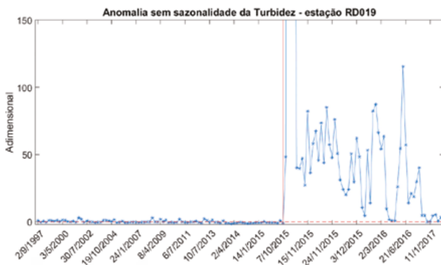
Figura 88 – Anomalia sem sazonalidade da turbidez para a estação RD019, localizada no rio Doce. Anomalia igual a zero (linha vermelha tracejada) antes e após a data do rompimento da barragem de Fundão (linha vermelha contínua).
