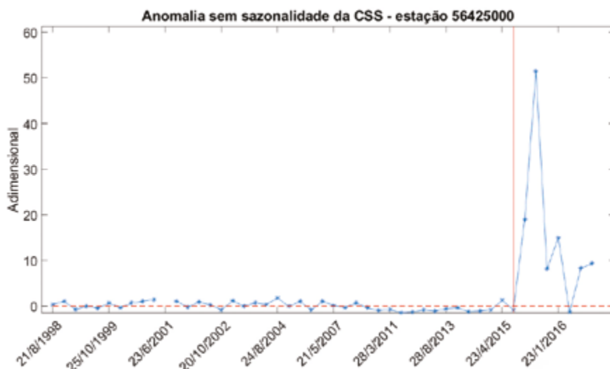
Figura 82 – Anomalia da CSS para a estação 56425000, localizada no rio Doce. Anomalia igual a zero (linha vermelha tracejada) antes e após a data do rompimento da barragem de Fundão (linha vermelha contínua).
