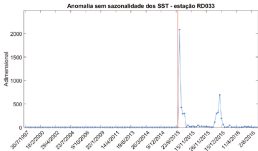
Figura 96 – Anomalia sem sazonalidade dos SSTs para a estação RD033, localizada no rio Doce. Anomalia igual a zero (linha vermelha tracejada) antes e após a data do rompimento da barragem de Fundão (linha vermelha contínua).
