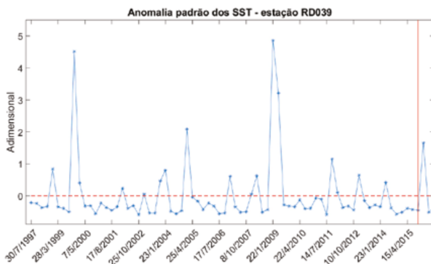
Figura 94 – Anomalia padrão dos SSTs para a estação RD039, localizada no rio Santo Antônio. Anomalia igual a zero (linha vermelha tracejada) antes e após a data do rompimento da barragem de Fundão (linha vermelha contínua).
