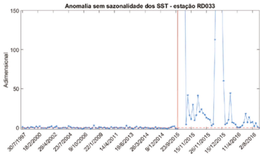
Figura 97 – Anomalia sem sazonalidade dos SSTs para a estação RD033, localizada no rio Doce. Anomalia igual a zero (linha vermelha tracejada) antes e após a data do rompimento da barragem de Fundão (linha vermelha contínua).
