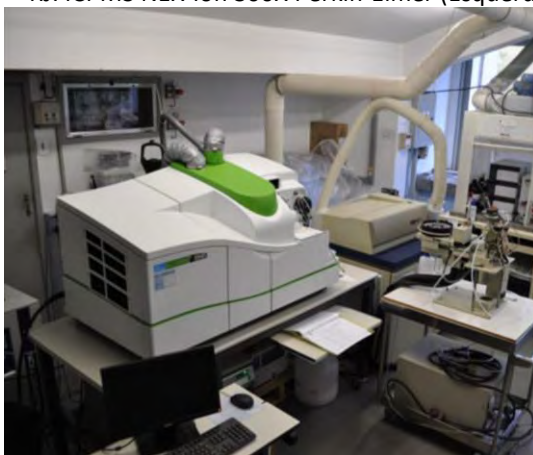
Figura 5 - Equipamentos utilizados para as análises químicas no Laboratório de Espectrometria de Massas da PUC-RJ: ICPMS NEX-Ion 300X Perkin-Elmer (Esquerda) e Laser Ablation CETAC LSX-213 (Direita).
