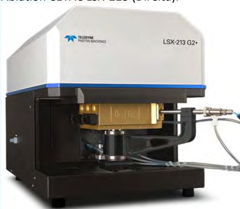
Figura 5 - Equipamentos utilizados para as análises químicas no Laboratório de Espectrometria de Massas da PUC-RJ: ICPMS NEX-Ion 300X Perkin-Elmer (Esquerda) e Laser Ablation CETAC LSX-213 (Direita).
