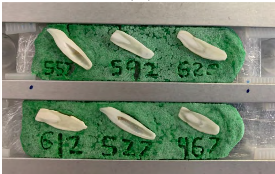
Figura 4 - Dentes de botos-cinza devidamente alinhados com massa de modelar e identificados para análise por ICP-MS.
