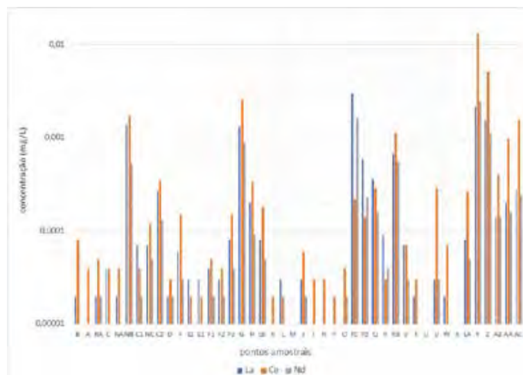
Figura 38 - Concentração máxima de ETRs nas estações amostrais do Lactec para controle da água subterrânea na BHRD.
