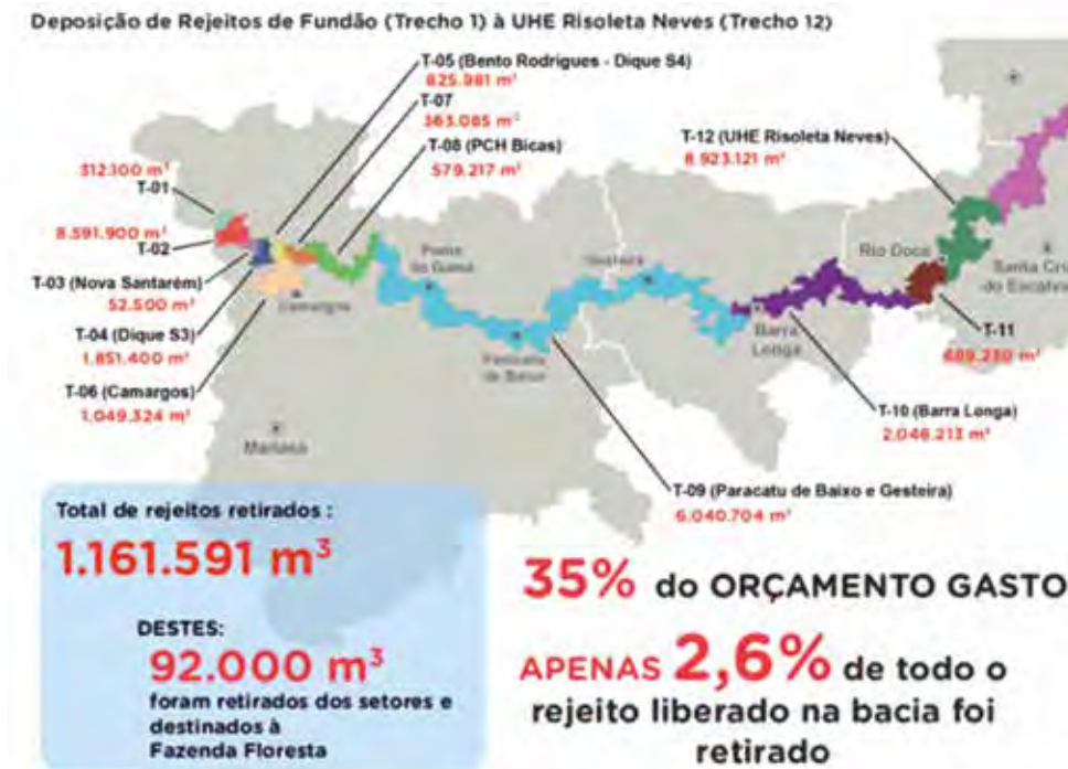
Figura 195 – Deposição de rejeitos no trecho compreendido entre a barragem de Fundão e a UHE Risoleta Neves (Fonte: Ramboll, 2019).
