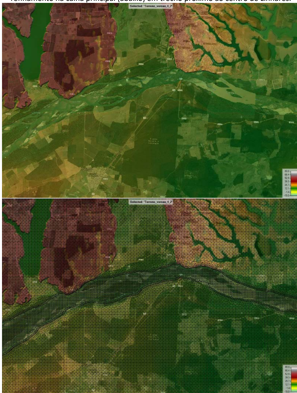
Figura 189 - Composição MDT e Google Earth (acima) e malha computacional em 200 x 200m com refinamento na calha principal (abaixo) em trecho próximo ao centro de Linhares.
