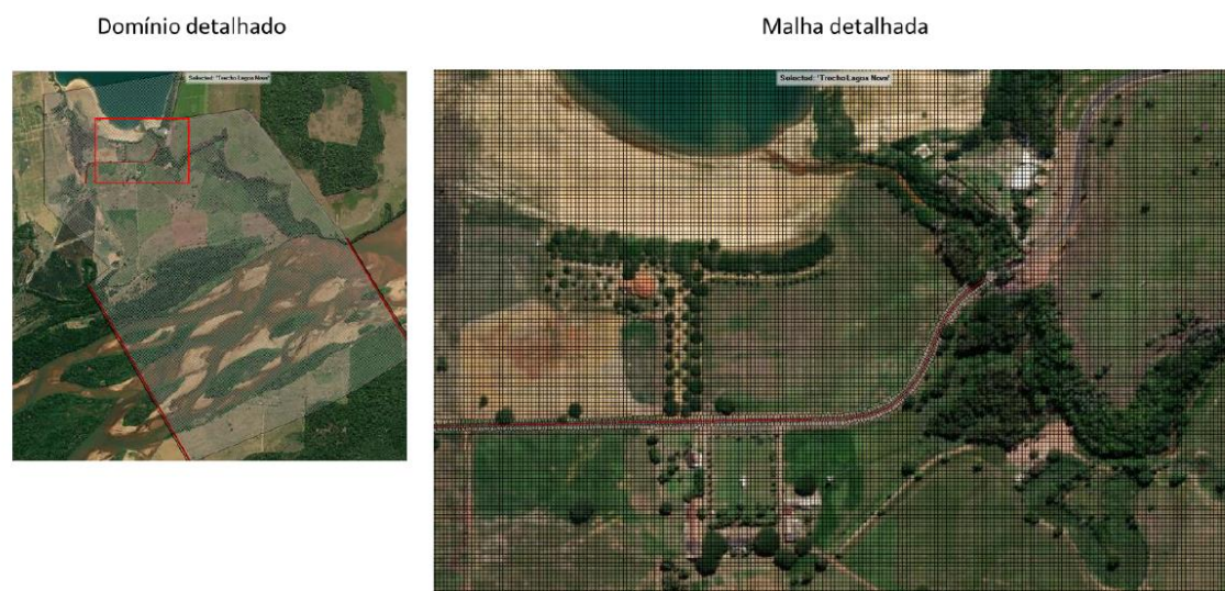
Figura 190 - Malha detalhada (5m x 5m) utilizada na simulação próximo à lagoa Nova.
