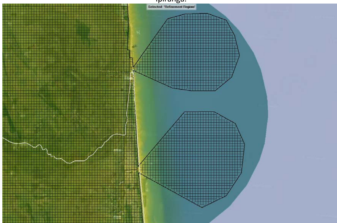
Figura 195 - Leque na costa onde localiza-se a condição de contorno de jusante na Barra Seca e rio Ipiranga.
