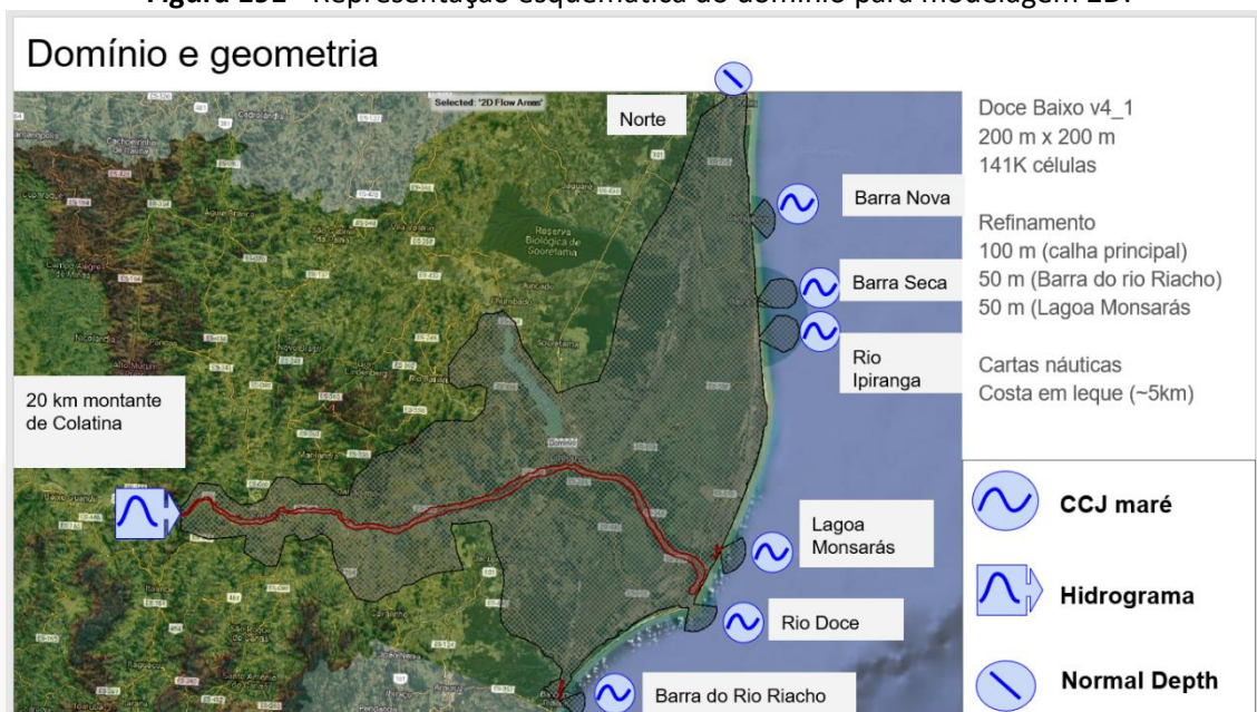
Figura 191 - Representação esquemática do domínio para modelagem 2D.
