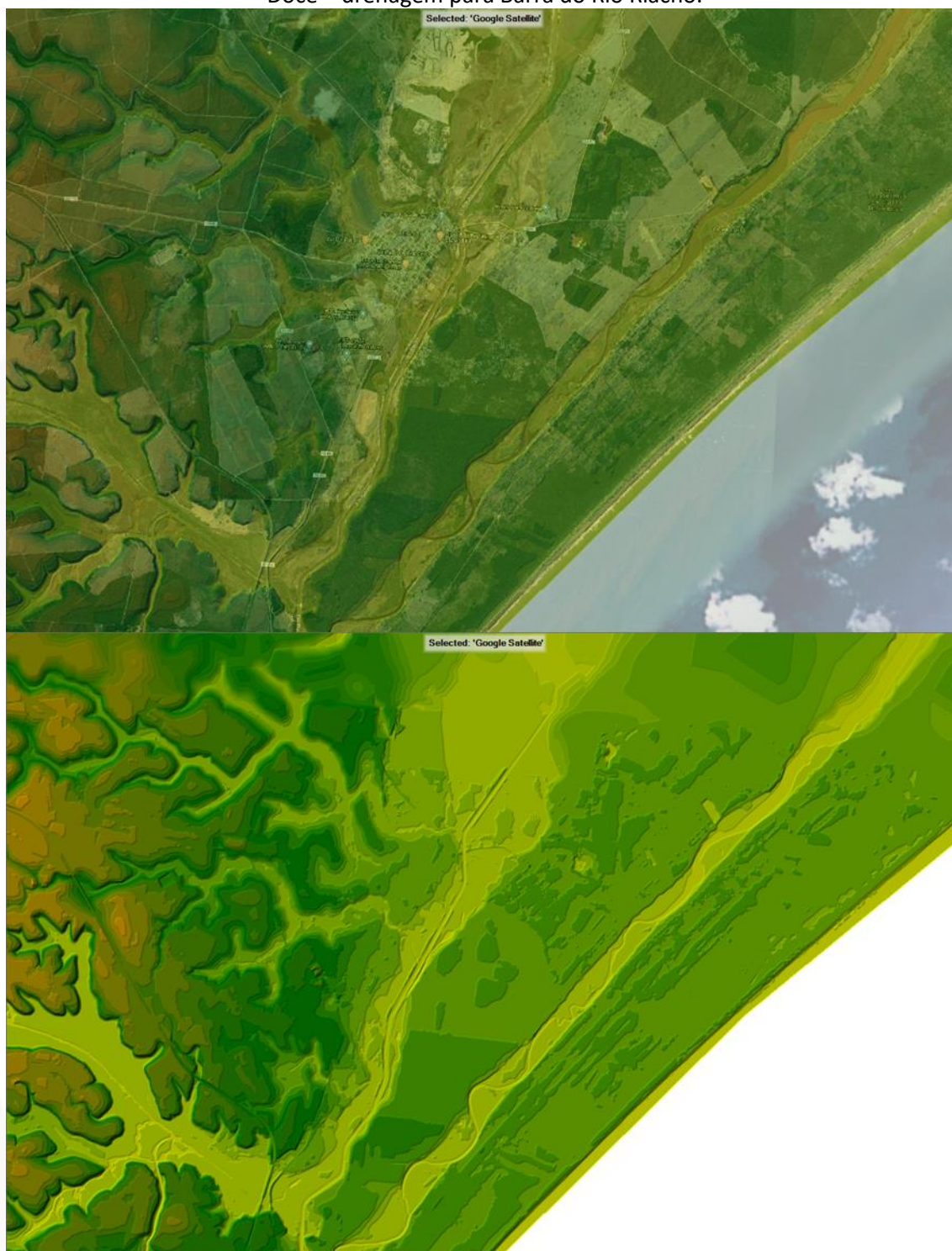
Figura 205 - Exemplo de canais identificados (acima) e escavado (abaixo) na margem direita do rio Doce – drenagem para Barra do Rio Riacho.
