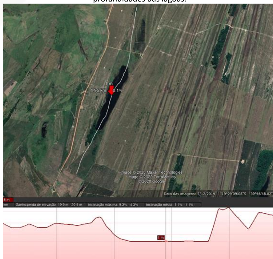
Figura 187 - Exemplo de perfil de elevação extraído do Google Earth para auxílio na estimativa das profundidades das lagoas.
