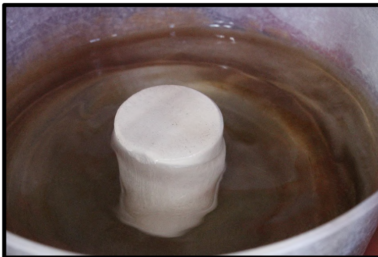
Figura 109 – Filtro de água com depósitos
