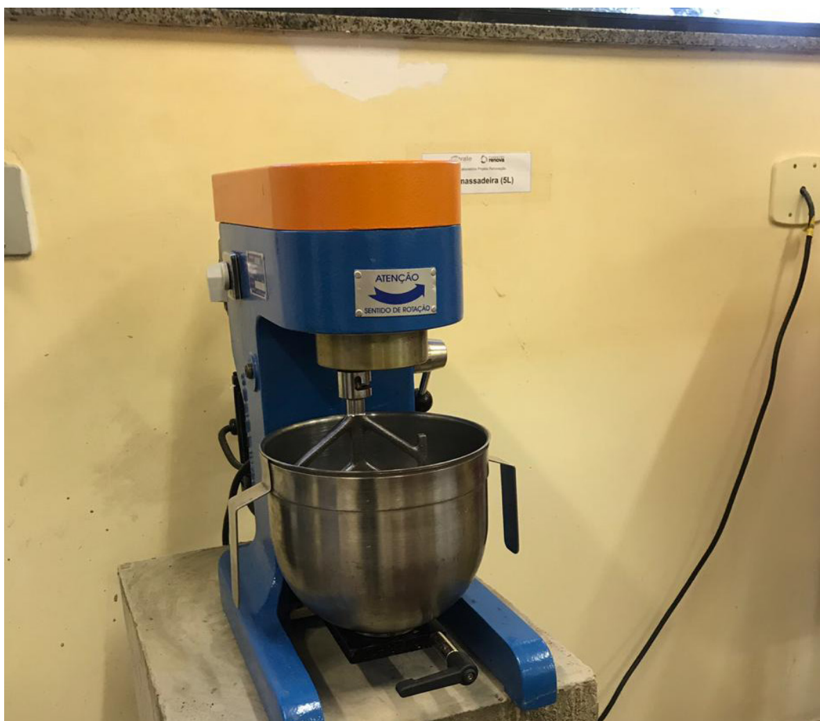
Argamassadeira utilizada para mistura de solo e cimento na pesquisa para uso produtivo dos rejeitos, fruto de convênio firmado pela Fundação Renova junto à Univale..
