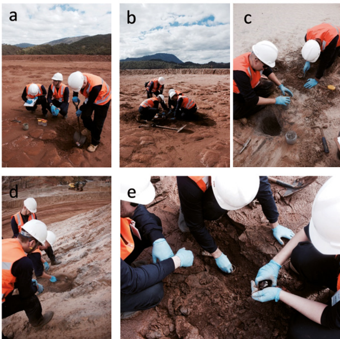
Figura 62 – Registro fotográfico das coletas de amostras deformadas e indeformadas de rejeito, realizadas em meados de julho de 2017, nas barragens de Germano (a-c), Fundão (d) e Santarém (e)
