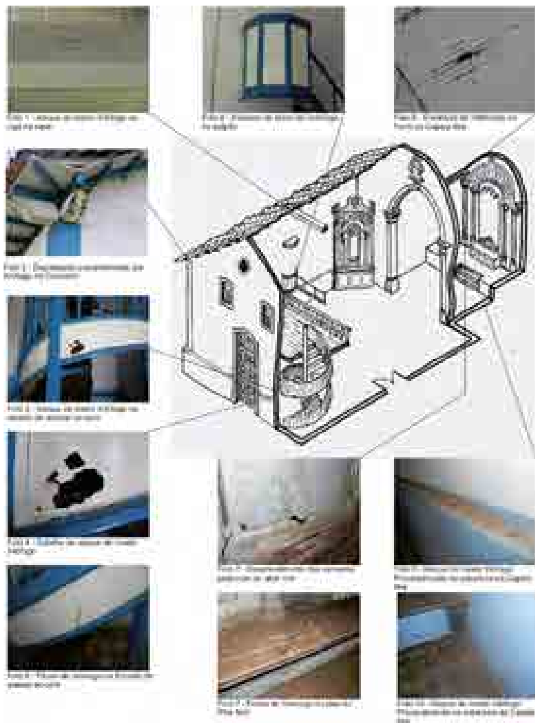
Figura 7: Croqui evidenciando os locais de danos à estrutura da edificação, com fotos indicativas. Desenho de Everaldo Cristiano da Silva.
