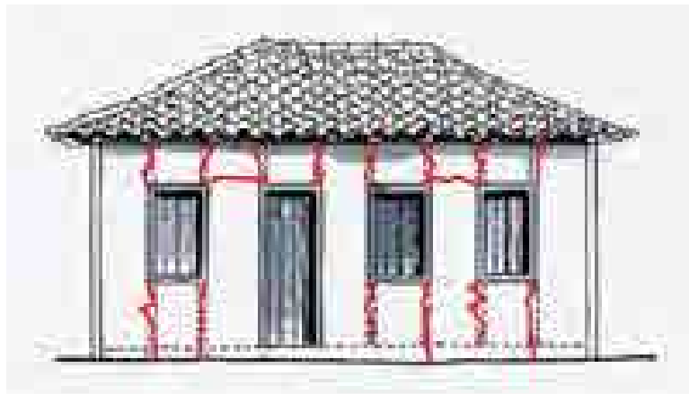
Figura 30 – Modelo de trincas ocorridas em gaiola de madeira com vedação de Taipa de Pilão
