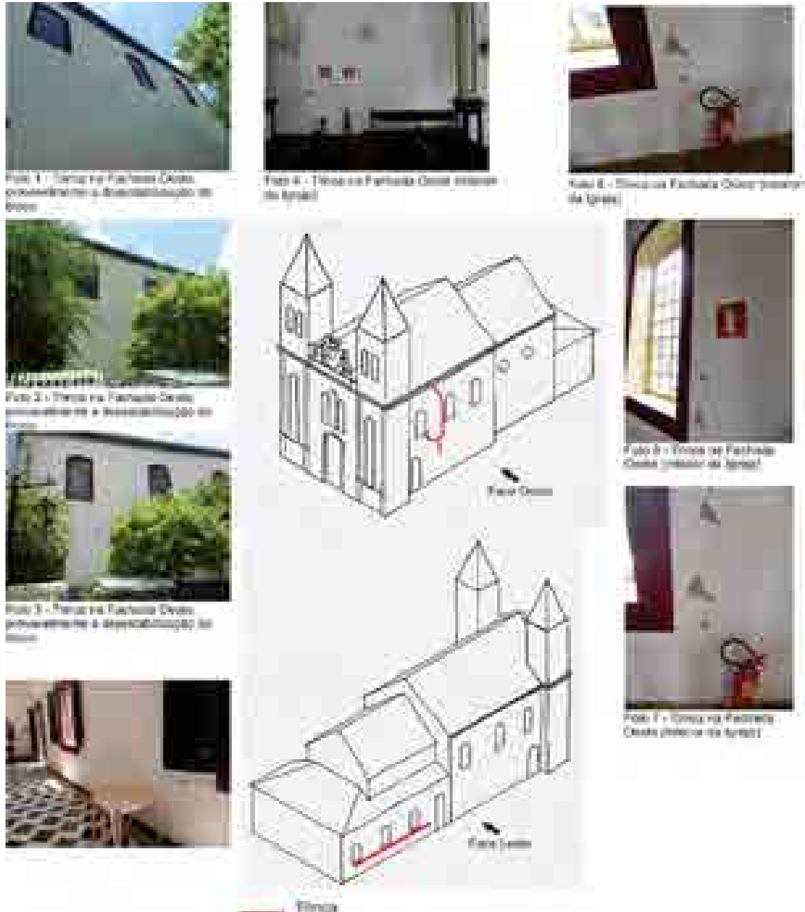
Figura 5: Croqui evidenciando os locais de danos à estrutura da edificação, com fotos indicativas. Desenho de Everaldo Cristiano da Silva.
