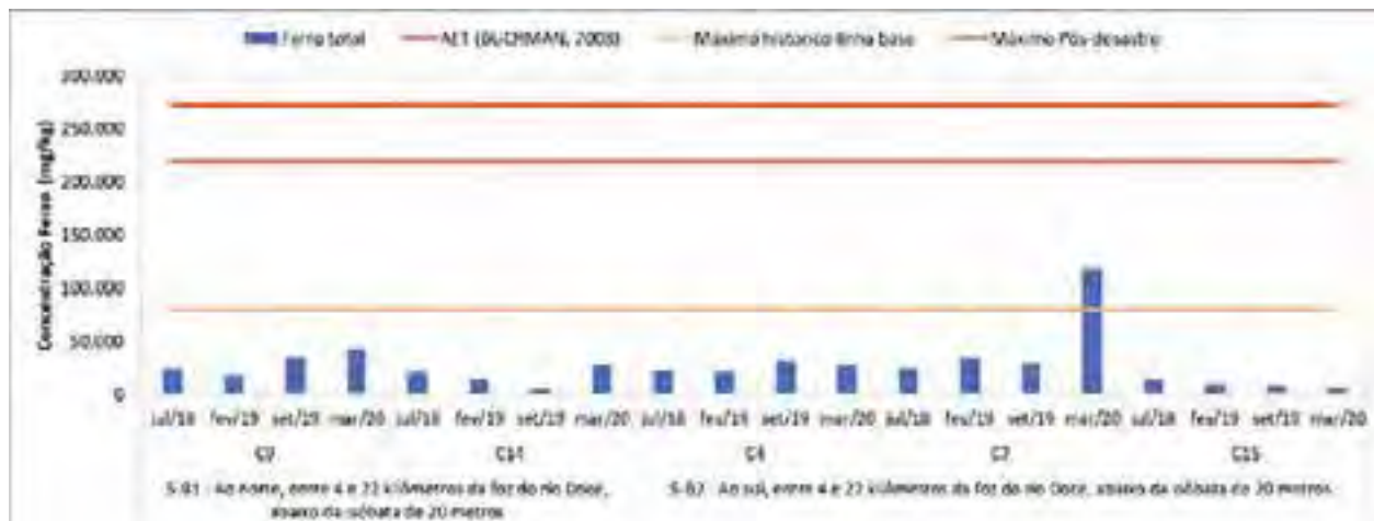
Figura 270 – Valores de ferro medidos pelo Lactec nas estações de monitoramento localizadas nos compartimentos 5-B1 e 5-B2, que representa a região localizada entre 4 e 22 quilômetros da foz do rio Doce até uma profundidade de 20 metros, e limites de referência (máximo histórico pré-rompimento, AET (BUCHMAN, 2008) e máximo atingido após a chegada da pluma na região costeira) utilizados para avaliação das alterações durante a cheia de 2020.
