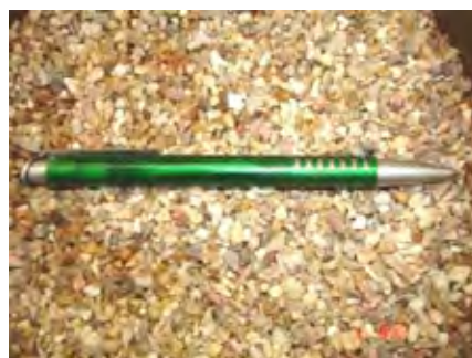
Figura 9 – Areia grossa, lavada, passada na peneira de 4,8mm e retida na peneira de 2mm
