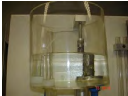
Figura 5 – Reservatório para fornecimento de água destilada a carga constante
