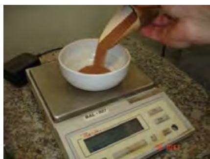
Figura 10 – Balança com resolução de 0,01g
