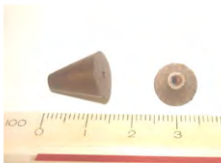
Figura 8 – Guia de centralização, com formato cônico e dotado de orifício de 1,5mm de diâmetro
