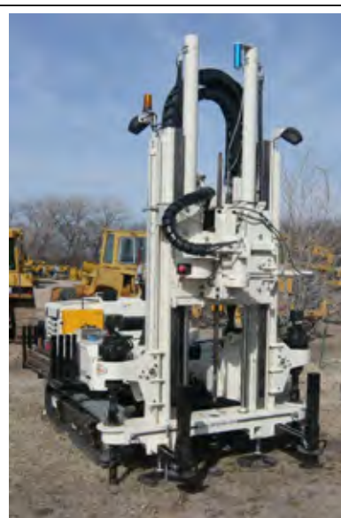
Equipamento para cravação de ponteira CPT-u, com capacidade de cravação de até 20tf
