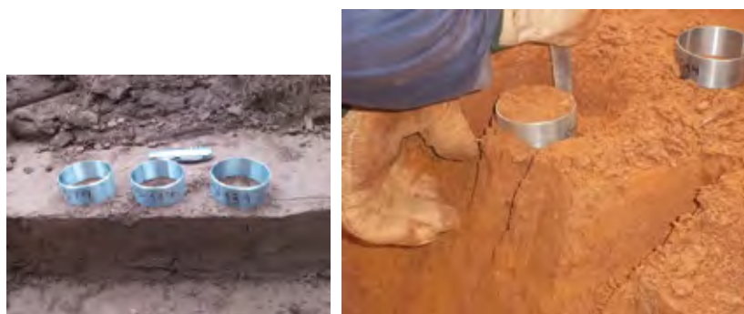
Figura 67 – Coleta de amostras indeformadas de rejeito e solo controle por meio de anéis de Kopecky para avaliação das características físicas.
