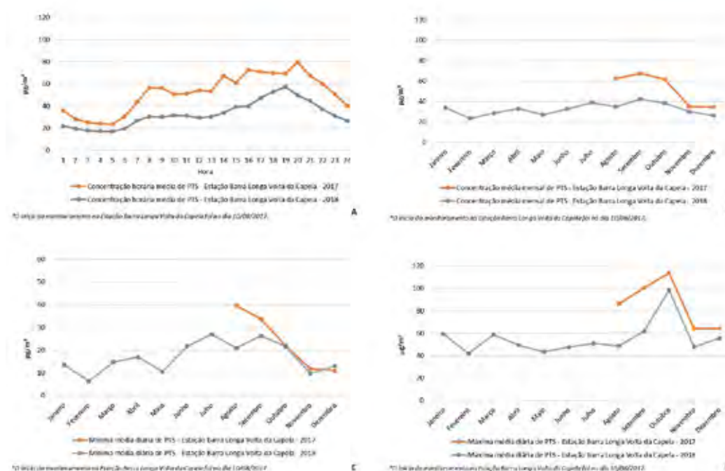
Figura 352 – Análise dos dados obtidos para partículas totais em suspensão (PTS) na estação Barra Longa Volta da Capela nos anos de 2017 e 2018. A. Variação média diária; B. Concentração média mensal; C. Concentração mínima média mensal; e D. Concentração máxima média mensal.
