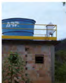
Figura 328 – Estação de amostragem de partículas totais em suspensão instalada em Bento Rodrigues – Mariana, MG
