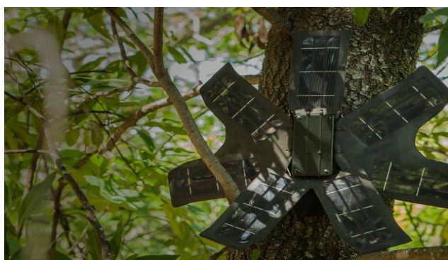
Os painéis fotovoltaicos foram adaptados por engenheiros da ONG norte-americana para a floresta tropical, onde a folhagem densa impede a captação de energia solar com placas tradicionais (Foto: Divulgação/Rainforest Connection)
