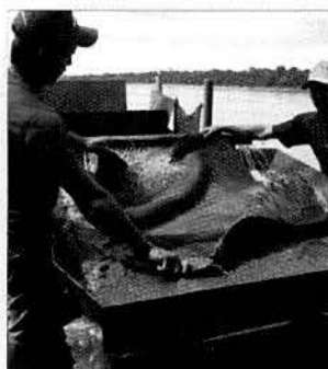
FOTO 05 – LAVAGEM DOS CARPETES PRA RETIRADA DO MINERAL MINÉRIO.
