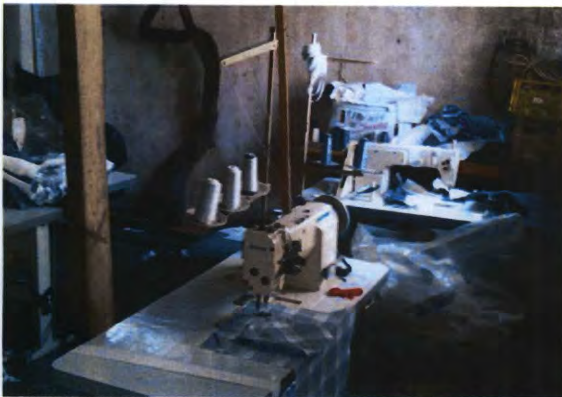
26/08/2013 – Oficina de costura sr. LUIZ VICTOR RAMOS VALDEZ. Máquinas de costura com partes móveis desprotegidas.
