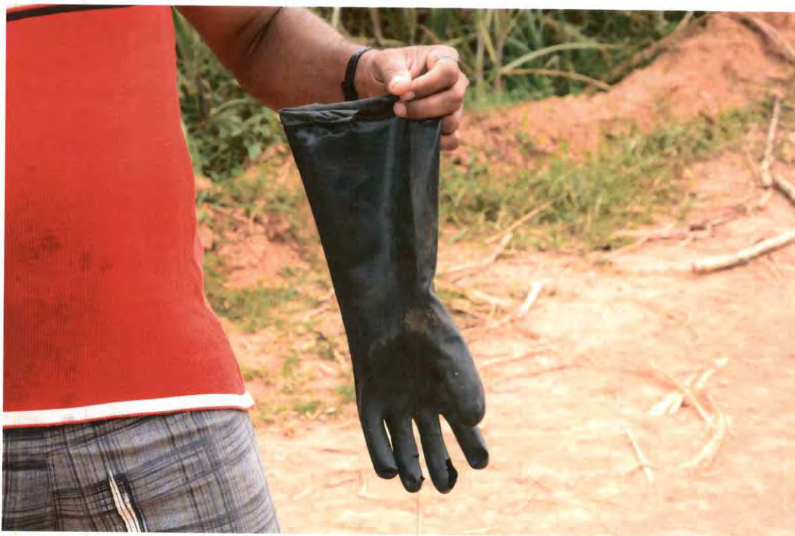
Foto 4: Luva de trabalhador inadequada e danificada
