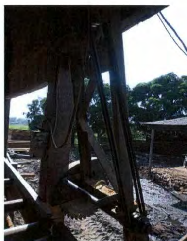
Fig. 3: Detalhe do tambor do eixo do carrinho desprotegido.
