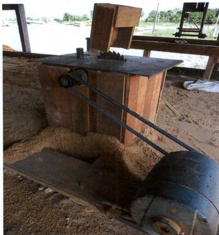
Fig. 5: Polia do motor da serra circular desprotegida.
