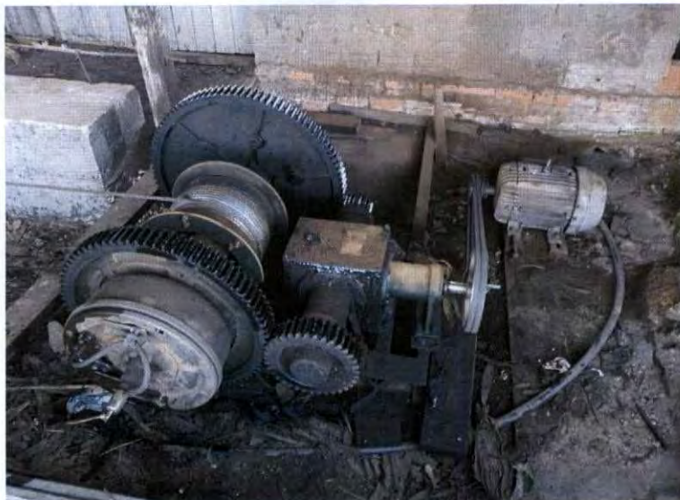
Fig. 2: Tambor do eixo do carrinho desprotegido.
