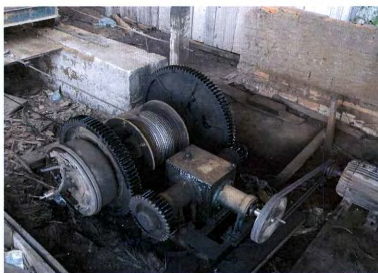
Fig. 3: Detalhe do tambor do eixo do carrinho desprotegido.
