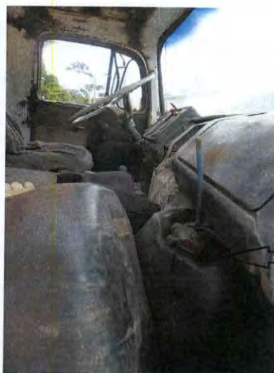
TANQUE DE COMBUSTÍVEL NA CABINE
