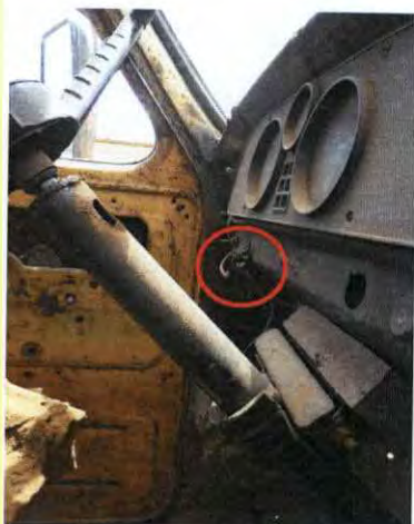
DETALHE DA FIAÇÃO ELÉTRICA EXPOSTA
