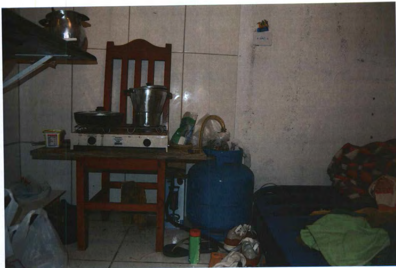
Alojamento situado à RUA JOSÉ DE MELO, 176 – FUNDOS - botijão de gás desprotegido e interno, ao lado do colchonete - risco de explosão
