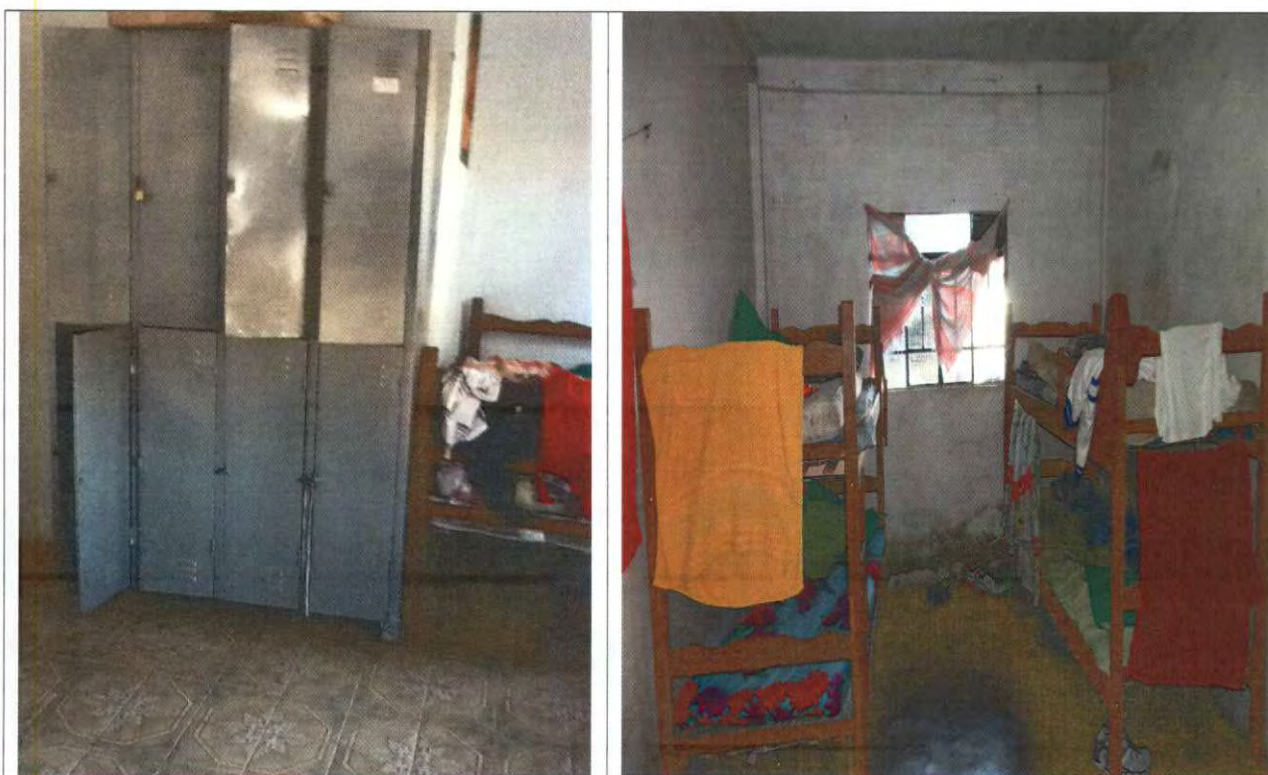
Foto 08: Armários individuais com dimensões inferiores àquelas previstas no item 18.4.2.10.7 da NR-18.
