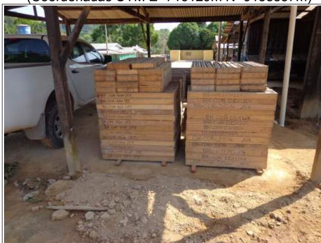
**FOTO 04** – Caixas de madeira com amostras de sondagens (testemunhas)
