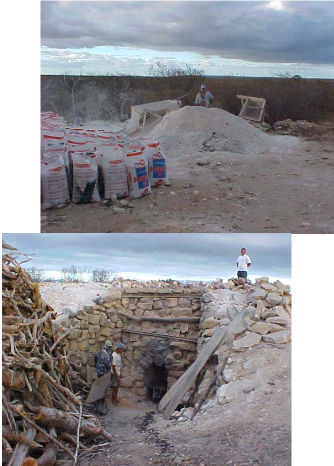
Figura 4. Assentados trabalhando na queima do calcário na fazenda Pe. João Maria II. Fotos da vistoria realizada pela equipe de auditoria entre os dias 21 e 24/7/2003.
