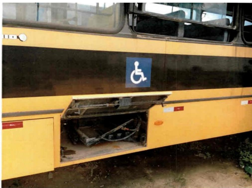
Foto – 10 Baterias do veículo foram retiradas
